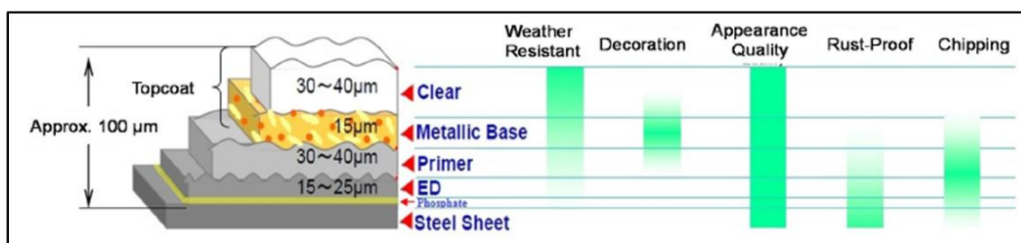
Figura 1 – Representação das camadas de tratamento e pintura, utilizadas em um sistema automotivo original (OEM).
