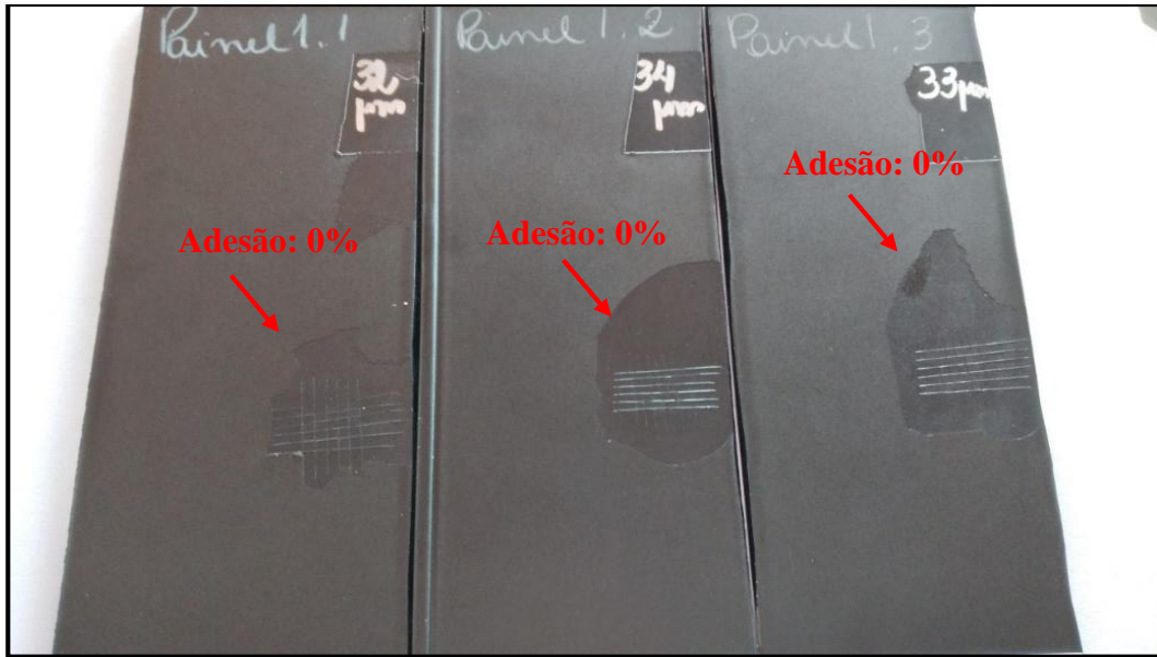
Figura 4 Painéis Grupo 1: Esmalte A (tal qual/sem promotor) sobre PP sem primer promotor. Fonte: autores (2021).
