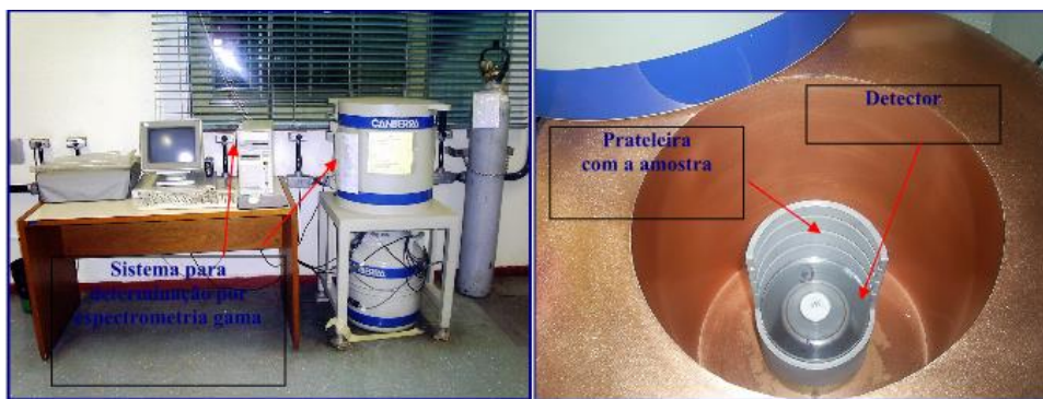
Figura 1 Detector de Ge hiperpuro acoplado à analisadores multicanais e a um microcomputador.
