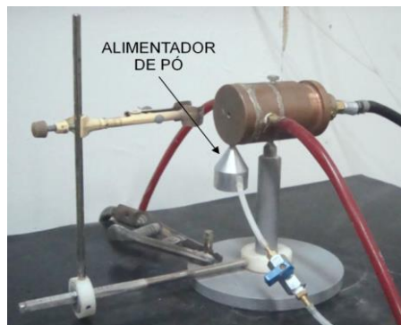
Figura 7 Fotografia da montagem da tocha de plasma com alimentador de pó.
