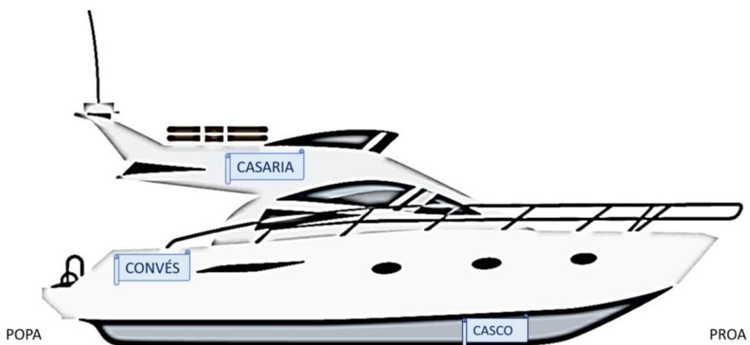
Figura 1 – Representação das partes que compõem um modelo de lancha.
